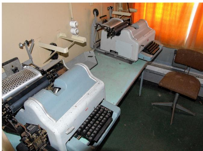
**Bemerkenswerte Technik:** Auf diesen Schreibmaschinen konnte Deutsch und Russisch geschrieben werden. Durch das Umlegen eines Hebels wurde die Sprache ausgewählt.
